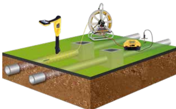
Ledningsspårning med rörål, sändare och sökare
