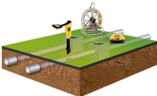
Lokalisering med rörål, sond, sändare och lokaliseringstrustning
